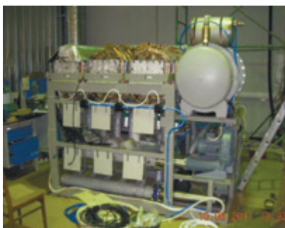
Комбинированная энергоустановка, работающая на дизельном топливе, мощностью 60 кВт. Высокий КПД достигается за счет включения в состав ЭУ помимо ЭХГ на основе PEMFC газотурбогенератора
