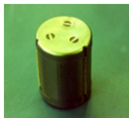
Интерметаллидный накопитель водорода на основе сплава LaNi 5 . Наиболее компактный (800 нл H 2 /дм 3 ) и безопасный способ хранения водорода
