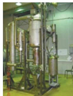
Комбинированная энергоустановка, работающая на дизельном топливе, мощностью 60 кВт. Высокий КПД достигается за счет включения в состав ЭУ помимо ЭХГ на основе PEMFC газотурбогенератора
