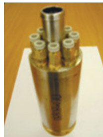
Струйный аппарат для обеспечения рециркуляции водорода (кислорода) в БТЭ без потребления электроэнергии
