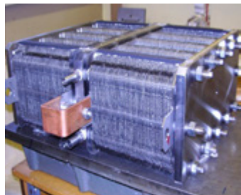
Батарея ТПТЭ, работающая на очищенном синтез-газе и воздухе с давлением реагентов, близким к атмосферному, электрической мощностью 6,5 кВт
