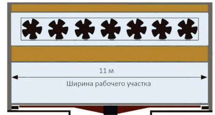
Рис. 3. Поперечный разрез ландшафтной аэродинамической трубы
