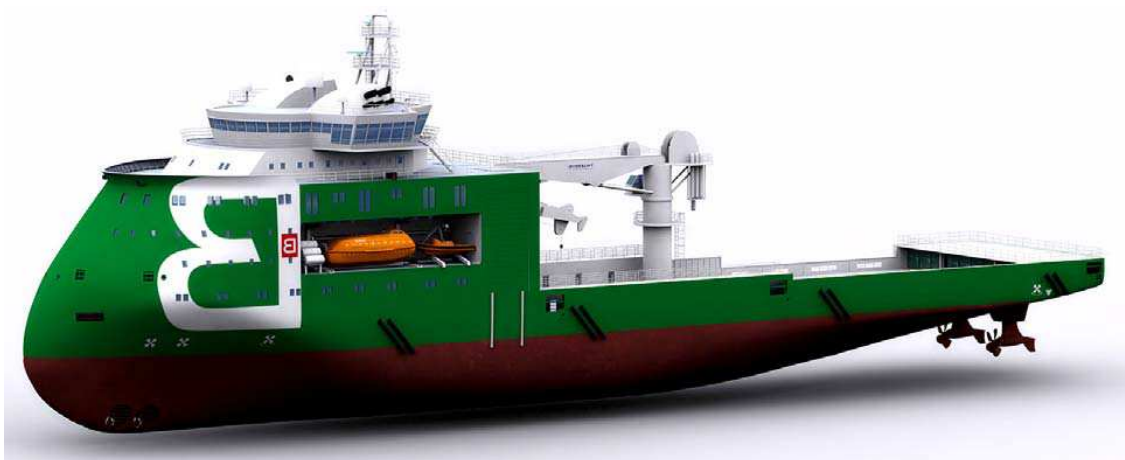
Рисунок 2.28 – Судно «Bourbon Orca» с завалом борта в носовой оконечности
