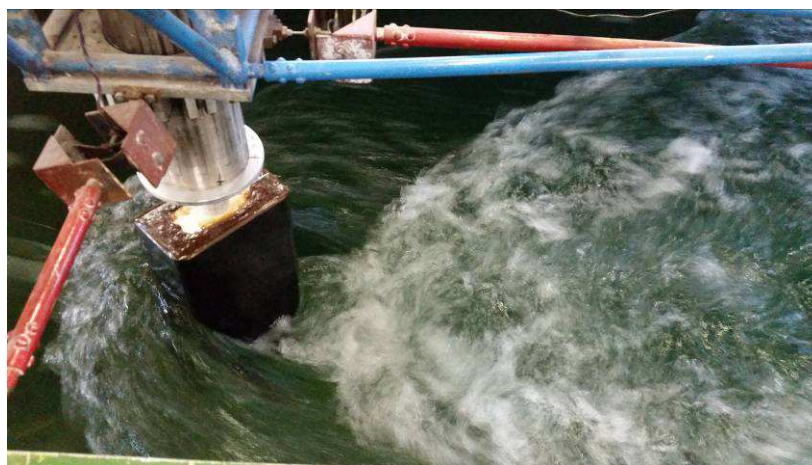
Рисунок 2.20 – Буксировка модели носовой оконечности судна
