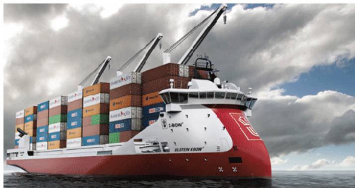
Рисунок 2.2 – Новое архитектурное решение при проектировании обводов носовой оконечности
