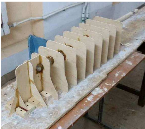
Рисунок 2.19 – Изготовление модели носовой оконечности судна
