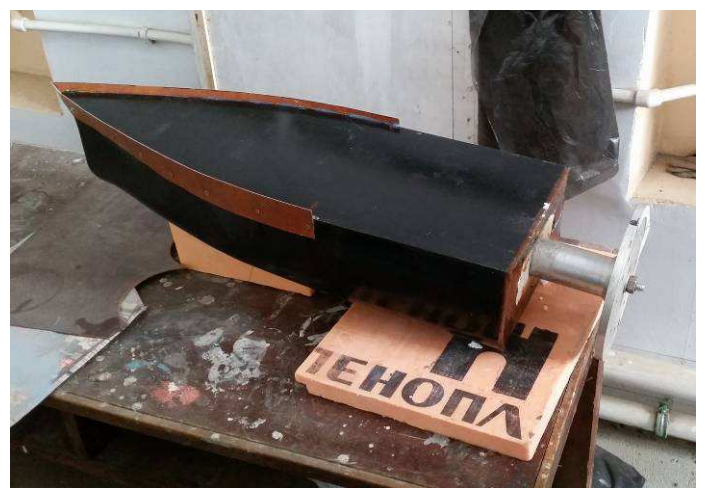
Рисунок 2.19 – Изготовление модели носовой оконечности судна
