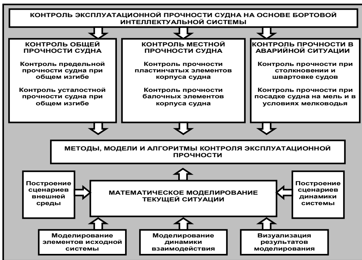
Рисунок 1.15 – Концептуальная модель интегрированного вычислительного комплекса контроля эксплуатационной прочности судна
