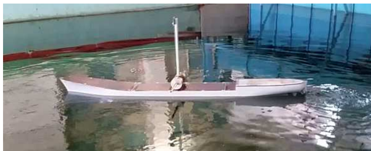
Рисунок 2.35 – Общий вид самоходной модели с седловатостью палубы
