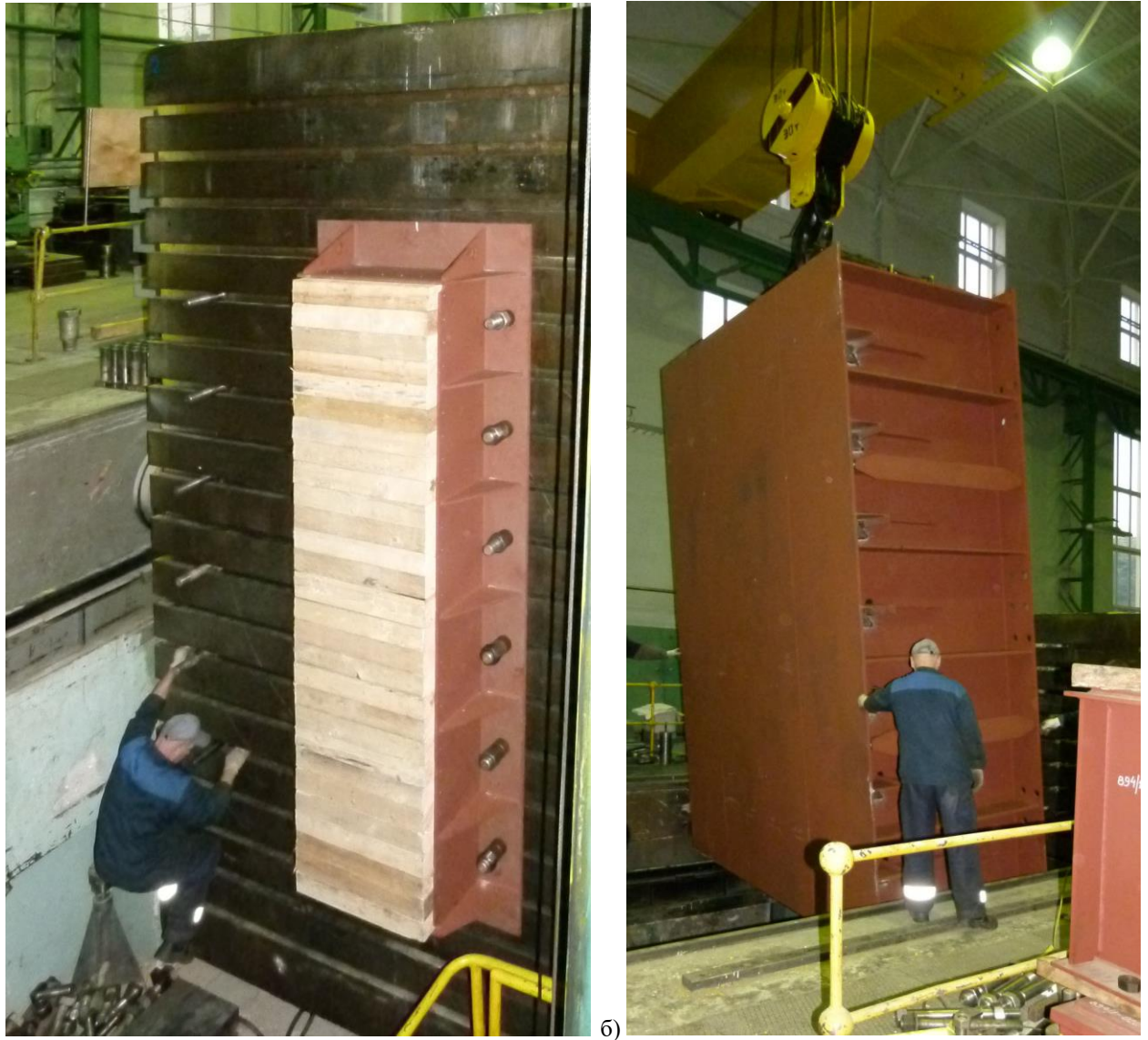
а) б) Рис. 3.47 – Установка индентора (а) и традиционной конструкции ледового пояса (б) на машину МУГ-3000
