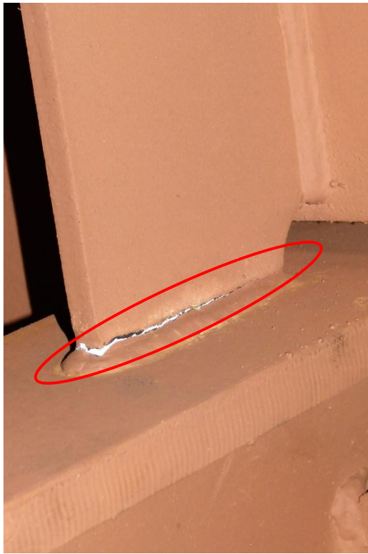
Рис. 3.64 – Начало отрыва пояска балки основного набора от кницы на опорном контуре при нагрузке 7 800 кН
