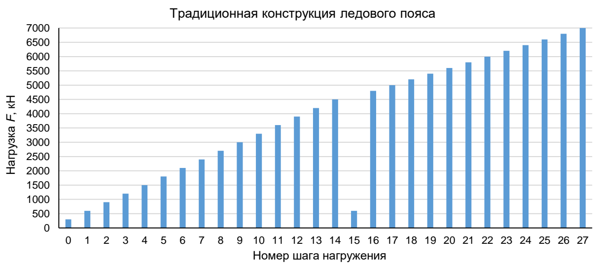
Рис. 3.48 – Диаграмма нагружения традиционной конструкции ледового пояса МЛСП
