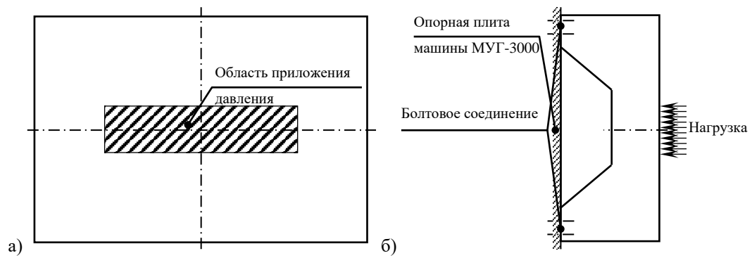
Рис. 3.45 – Схема закрепления и нагружения конструкции перекрытия ледового пояса МЛСП: а) план с внешней стороны обшивки; б) вид сбоку
