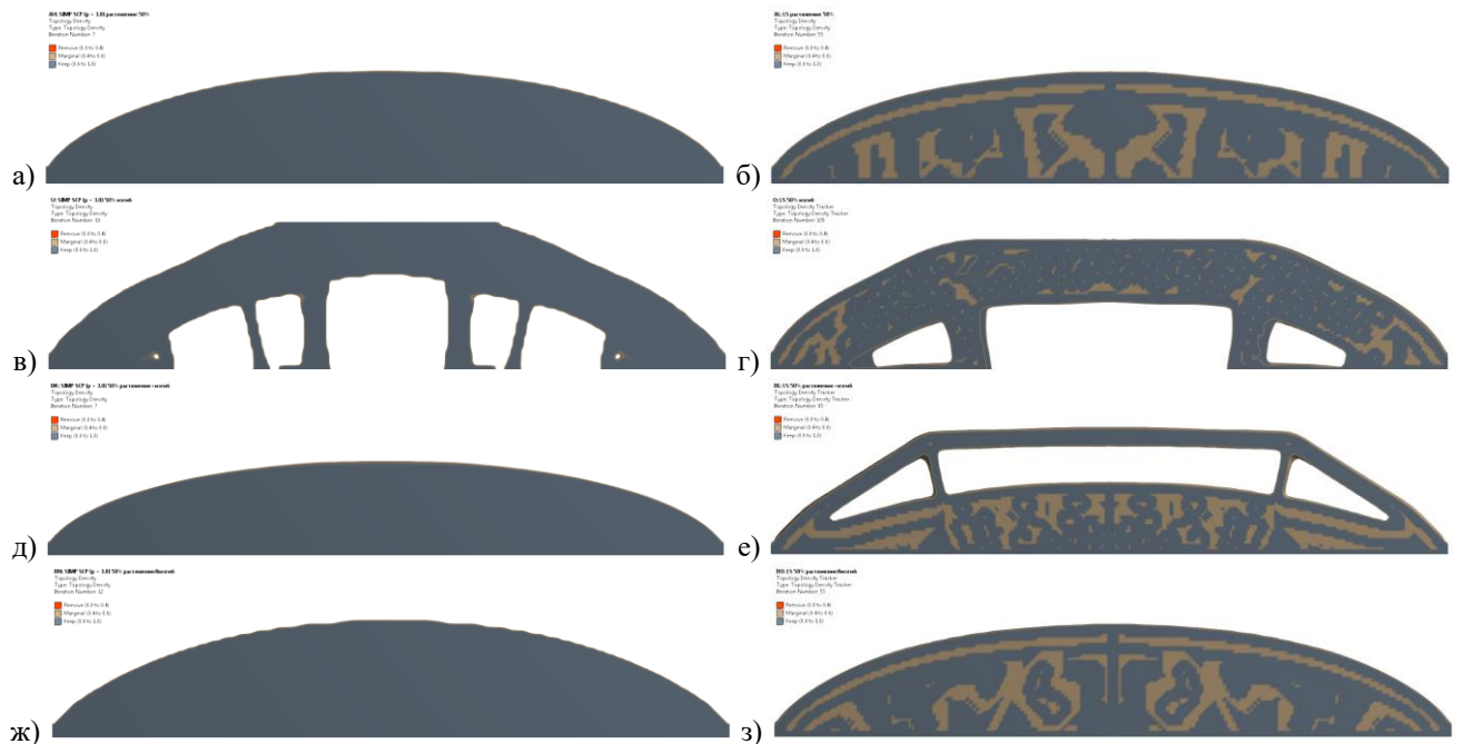
Рис. 3.15 – Результаты ТО листового ПЭ при действии - растягивающего напряжения 100 МПа: а) SIMP ПВП, p = 3.0 ; б) LS; - изгибающего давления 0,1 МПа: в) SIMP ПВП, p = 3.0 ; г) LS - растягивающего напряжения и изгибающего давления по отдельности: д) SIMP ПВП, p = 3.0 ; е) LS - растягивающего напряжения и изгибающего давления одновременно: ж) SIMP ПВП, p = 3.0 ; з) LS
