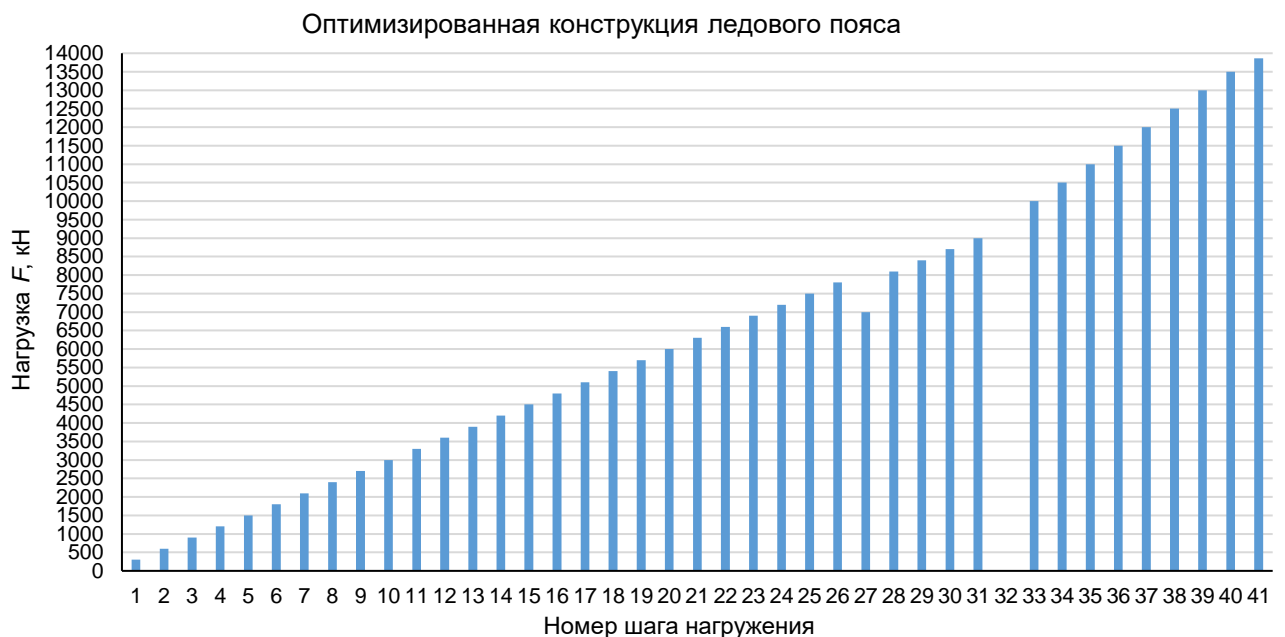
Рис. 3.63 – Диаграмма нагружения оптимизированной конструкции ледового пояса МЛСП
