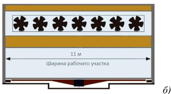
Рисунок 1 - Схема Ландшафтной аэродинамической трубы: а) продольный разрез, б) поперечный разрез
